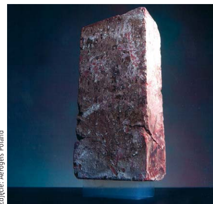
Fot. Kostka aerożelu podtrzymująca ważącą ponad 1000-krotnie więcej cegłę
